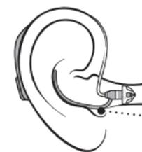
Insérez doucement l'embout dans votre conduit auditif jusqu'à ce que le fil de l'écouteur se loge dans votre oreille.
